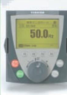
LCD延长面板为8行11个文字显示，可通过旋钮操作选择参数，进而简便地进行设定，监控。适用于日语、英语、德语、葡萄牙语。作为盘面安装用选项件，备用IP54适用配件。而且，也同样可以安装到主机上。
