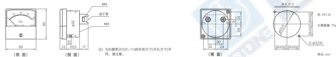
注) 与旧频率计(QY-11)的外形尺寸(开孔尺寸)不同, 请注意。
